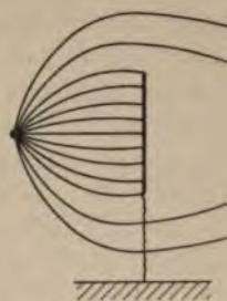
Abb. 26. Schirmwirkung einer zur Erde abgeleiteten Fläche.
